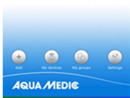
Fig. 13 : Sous le point de menu « My groups », il est possible de combiner plusieurs pompes en un seul groupe et de les programmer ensemble.
