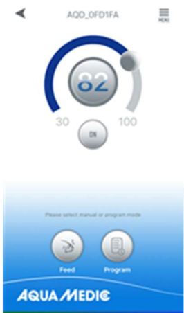
Rys. 9: "PROGRAM" – ten przycisk służy do programowania pracy pompy.
